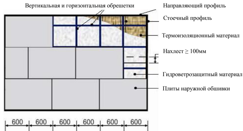
Рис. 12. Крепление наружной обшивки к каркасу
